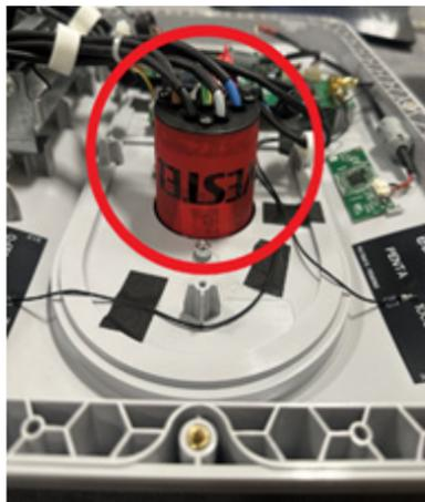
**2.** Die Stellen, an denen der Zähler die Datenübertragung vornimmt, sind versiegelt. Für die Sicherheit des MID-Zählers sind zwei Plomben angebracht, wie in der Abbildung unten gezeigt. Auch an der ACPW-Platine gibt es Ein- und Ausgänge. An der Stromversorgungsplatine sind zwei Plomben angebracht, wie in der Abbildung unten dargestellt, um die Sicherheit der Platine zu gewährleisten.
